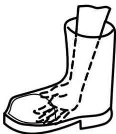
f) Deterioramento della fodera, bordi taglienti
