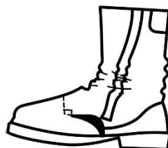
c) Separação do material superior
