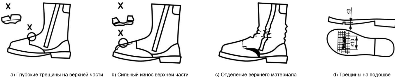
а) Глубокие трещины на верхней части б) Сильный износ верхней части в) Отделение верхнего материала д) Трещины на подошве
