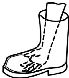
f) Destrukcija podstave, oštri krajevi
