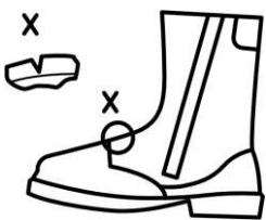
a) Dype sprekker i overdelen
