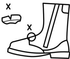
a) Duboke pukotine lica
