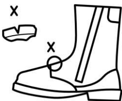
a) Fisuri adânci fețe
