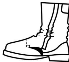
c) Oddělování materiálu vrchu
