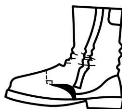
c) Separering av ovan delens material
