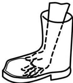
f) Destrukce podšívky, ostré okraje
