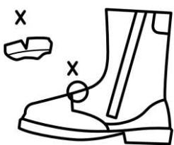
a) Djupa sprickor i ovandelen
