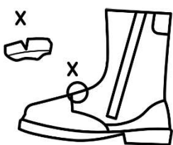
a) Globoke razpoke na zgornjem delu
