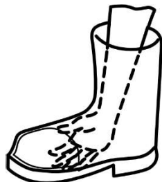
f) Destruição do forro, bordas afiadas
