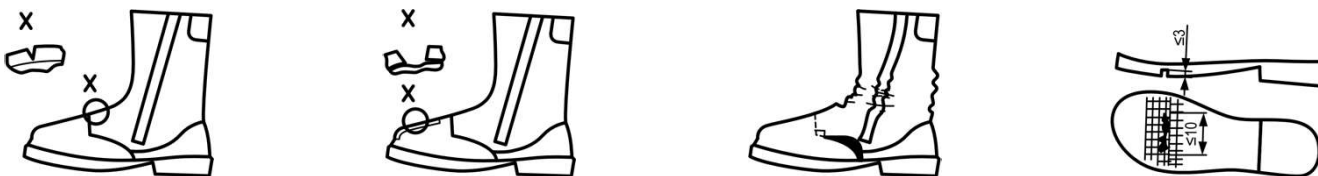
a) Fissures profondes dans la tige b) Importante abrasion de la tige c) Séparation du matériau supérieur d) Fissures dans la semelle
