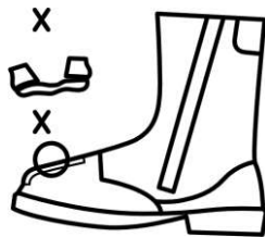
b) Značné odření vrchu
