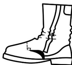
c) Ločevanje materiala zgornjega dela
