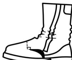
c) Materialet overdelen er laget av har skilt seg fra hverandre
