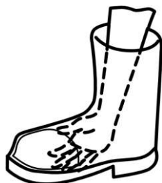
f) förstöring av foder, skarpa kanter
